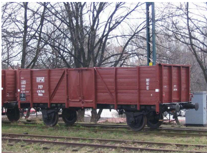
Węglarka typu 4W na torze 66. Dobrze widoczne oznakowanie z lat 60tych, łącznie z oznaczeniem "OPW". Fot. autor
